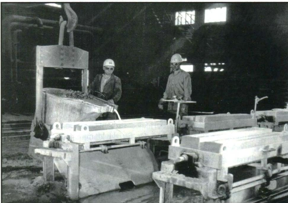
**Abbildung 68:** Gießen von Wirebars
