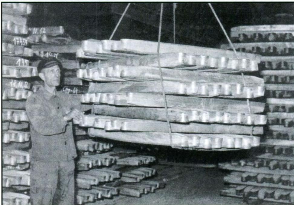
**Abbildung 67:** Verladen von Wirebars
