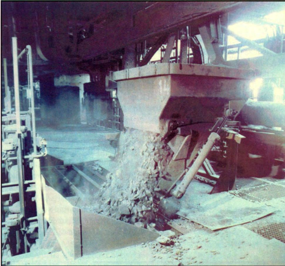
**Abbildung 58:** Elektrohängebahn (Transportkübel zur Begichtung der Öfen)
