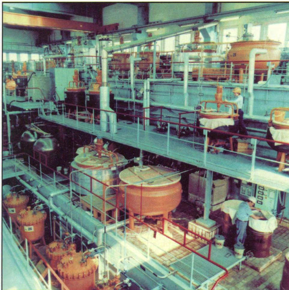
**Abbildung 78:** Laugestation der Zinkvitriolanlage
