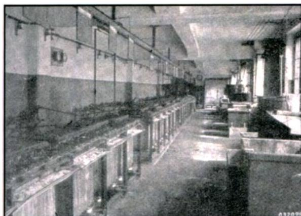
**Abbildung 49:** Bäderhalle der Silberelektrolyse
