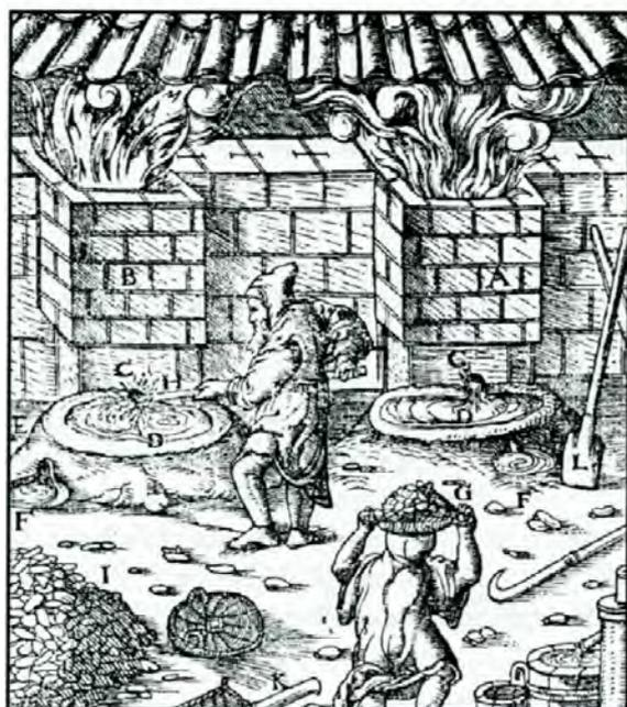
**Abbildung 2:** Schachtofen (nach Agricola), wie er vermutlich zum Schmelzen des Kupferschiefers zwischen 1515 und 1570 verwendet wurde
