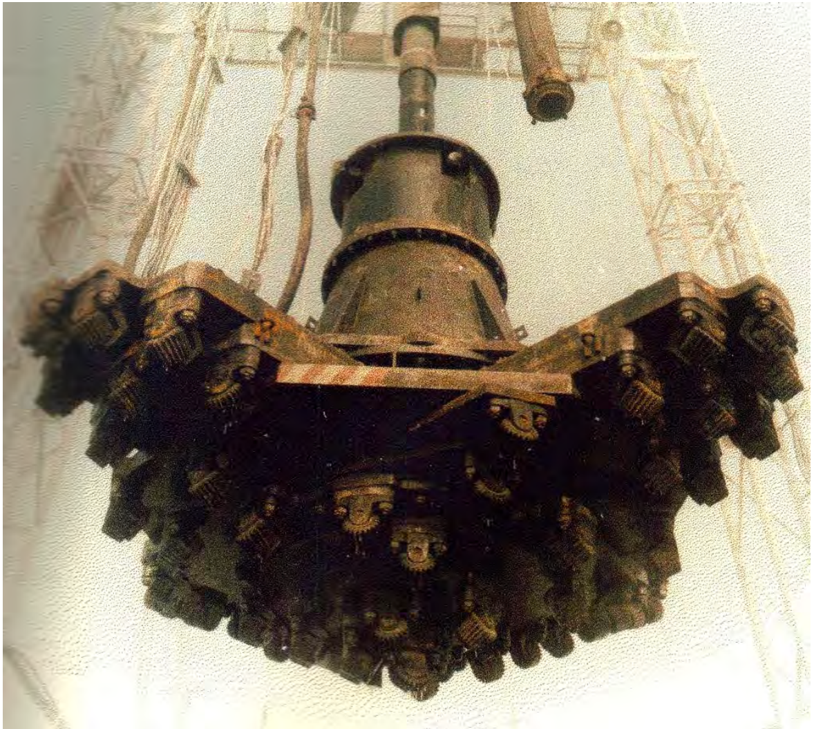
Abb. 26: Bohrwerkzeug für den Schacht Holdenstedt (5,3 m Ø)
