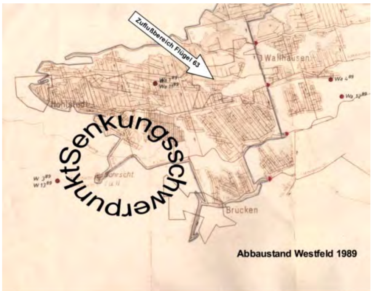
Abb. 17: Lage der Hauptzuflussstelle im Westfeld des Schachtes Sangerhausen
