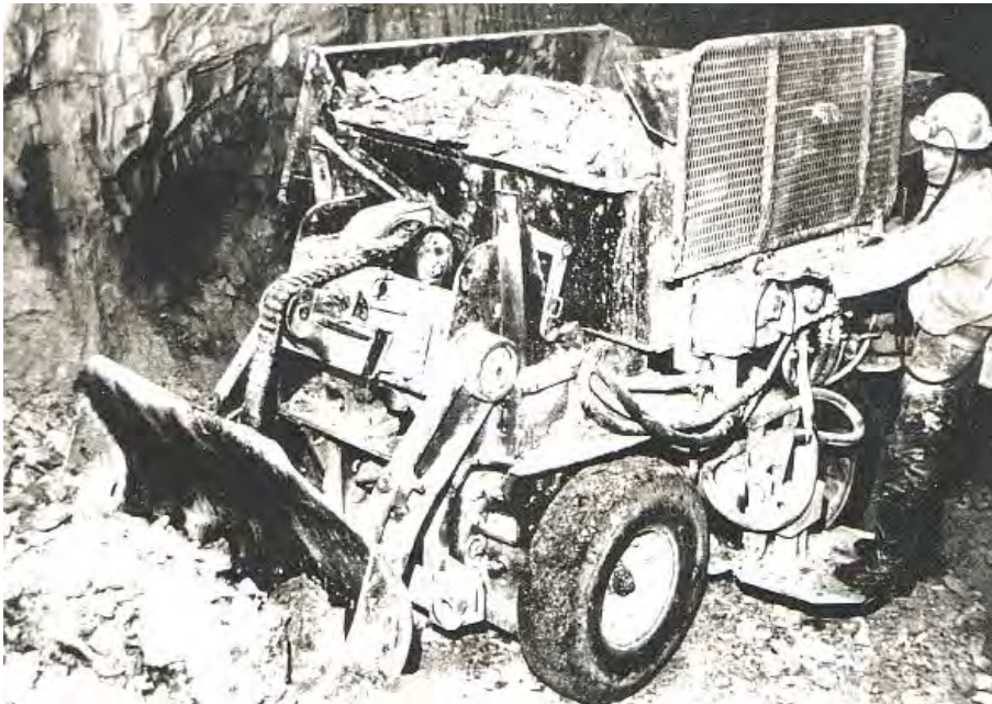
Abb. 24: Gleisloser Bunkerlader im Einsatz
