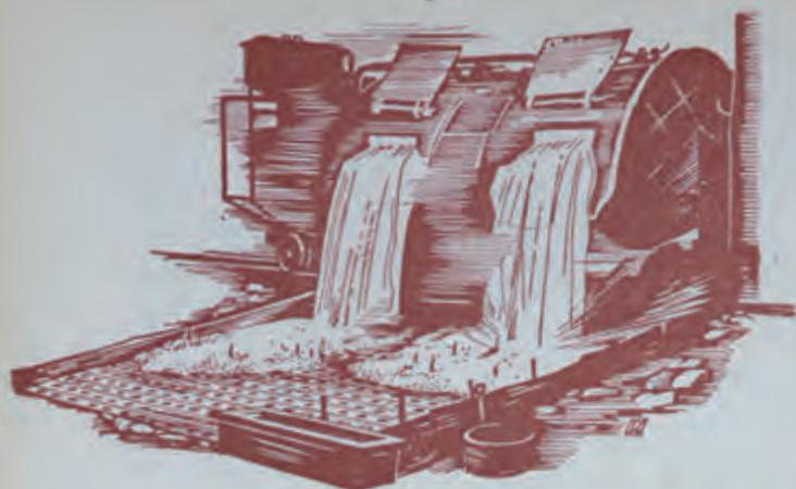
Seine Gleichmäßigkeit in der äußeren Form und inneren Festigkeit macht ihn gegenüber allen Naturpflastersteinen überlegen. Wegen der Regelmäßigkeit der Steine, der hierdurch bedingten engen Fugen und der graden Kopffläche gewährleisten die mit Schlacken gepflasterten Straßen bei stärkstem Verkehr ein Höchstmaß von Erschütterungsfreiheit und Widerstandsfähigkeit gegenüber Abnutzung. Das Pflaster bleibt im Gegensatz zu an-
