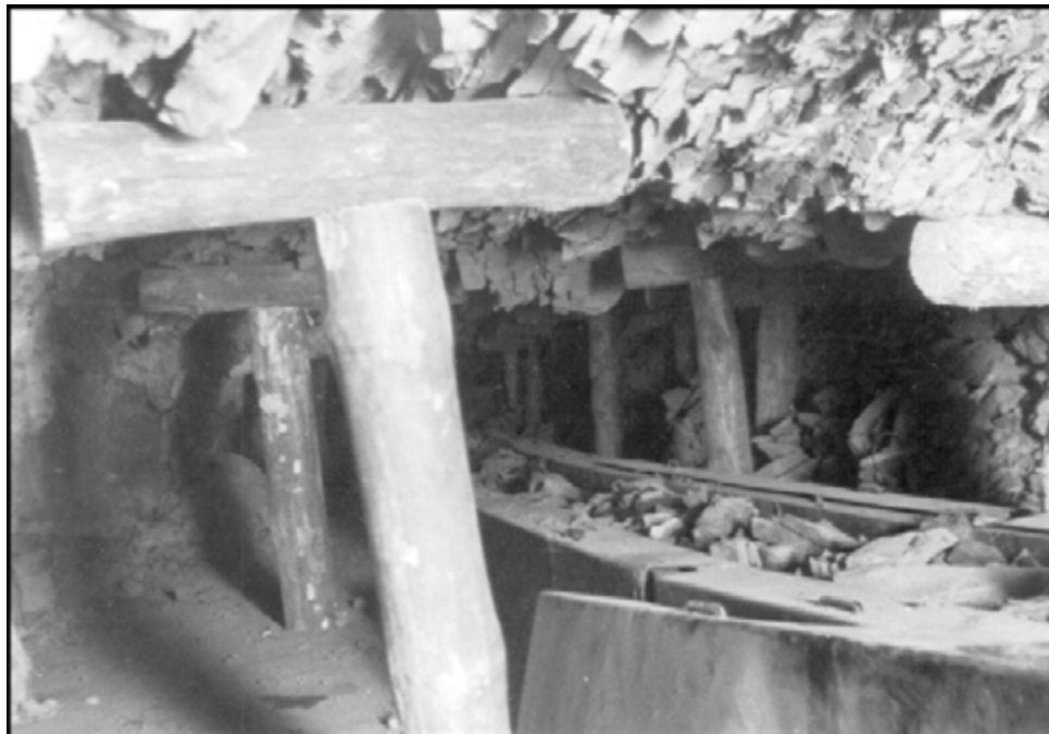
Abbildung 82: Mit Haufwerk beladenes Plattenförderband im Strebbereich
