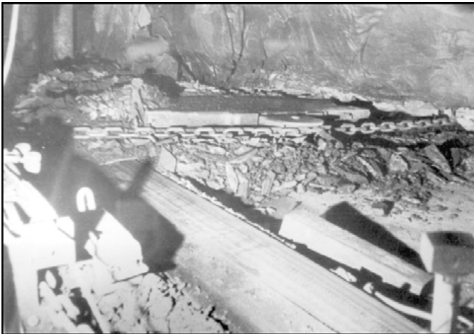
Abbildung 98: Gefülltes Schrappegefäß im Strebaushieb
