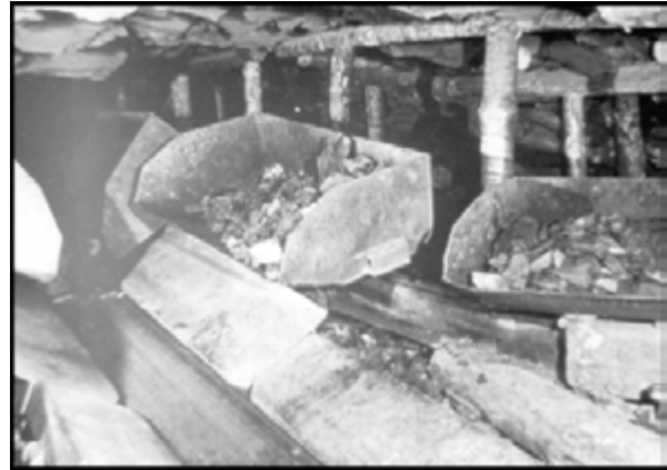
Abbildung 87: Einschienenfördergondeln zum Zeitpunkt der selbständigen Entladung an der Kippstation auf ein in der Förderfahrt verlegtes Gummigurtförderband
