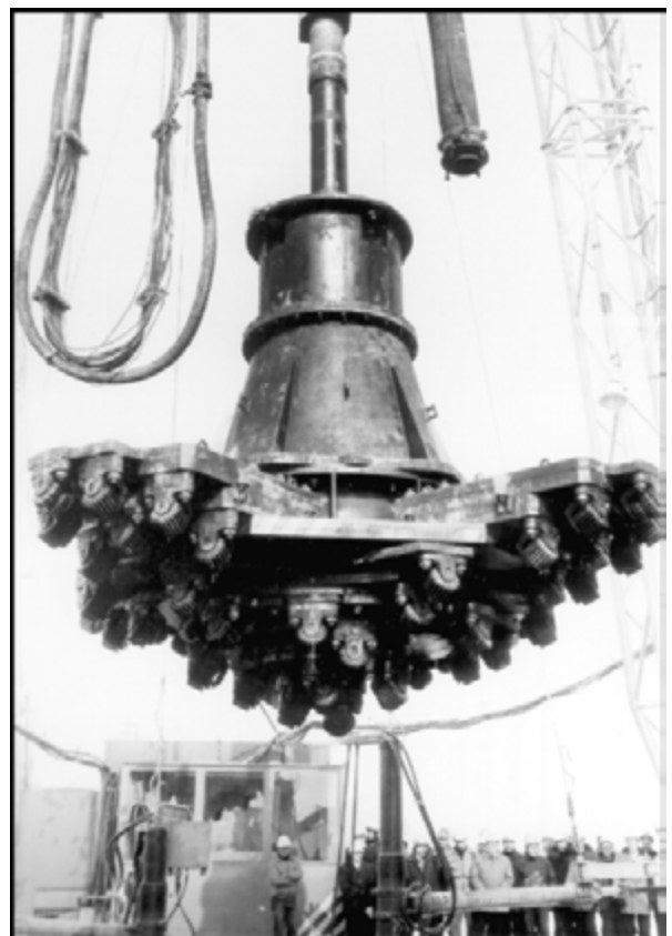
Abbildung 41: Schachtbohrgerät (Bohrkopf) Schachtbau Nordhausen
