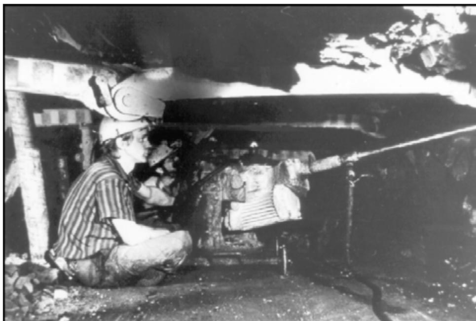
Abbildung 92: Abbohren des ausgeerzten Strebtes mit elektrischer Strebbohrmaschine
